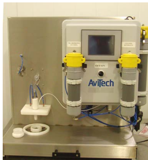
Figura 1. La máquina Intellilab®. Este modelo inyecta un huevo a la vez y es la versión a menor escala de Intelliject® la máquina comercial de Avitech.
